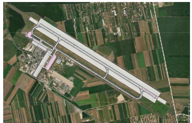
Slika 2. Prikaz trenutne referentne mreže aerodroma Nikola Tesla definisane u sistemu za upravljanje održavanjem Izvor: Preuzeto iz aerodromskog sistema za upravljanje održavanjem kolovoznih konstrukcija
