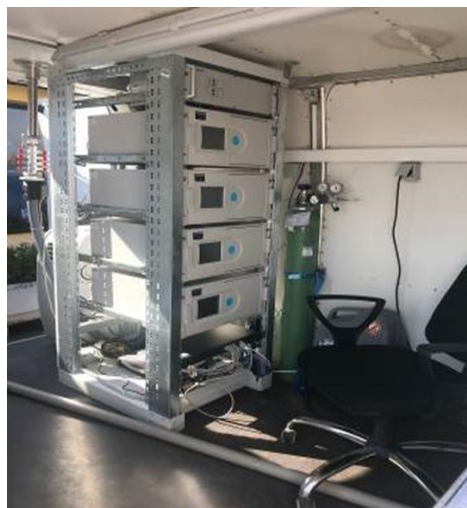
Slika 3. Analizatori SO 2 , NO/NO 2 /NO x , CO, O 3 HORIBA JAPAN Izvor: (Institut za građevinarstvo „IG“ doo Banja Luka)
