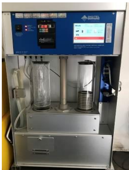
Slika 1. Gravimetrijski uzorkivač čvrstih čestica TSP, PM 10 i PM 2.5 Izvor: (Institut za građevinarstvo „IG“ doo Banja Luka)
