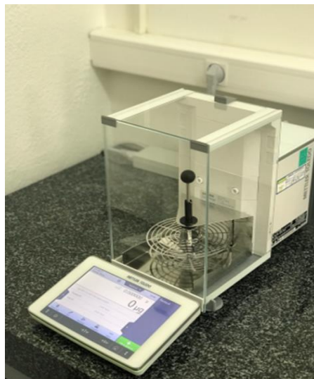
Slika 2. Elektronička vaga METTLER TOLEDO Izvor: (Institut za građevinarstvo „IG“ doo Banja Luka)
