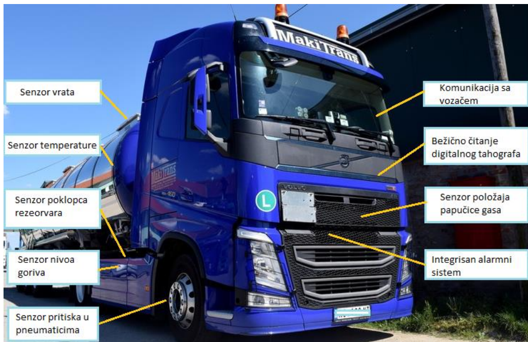
Slika 1. Ugrađeni senzori u vozilo i njihova lokacija
