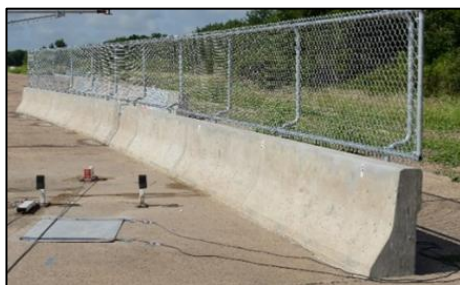
Слика 6. Изглед челичне мреже (дodatка) на бетонској огради на полигону за тестирање Извор: Тексас А&М Транспортни институт
