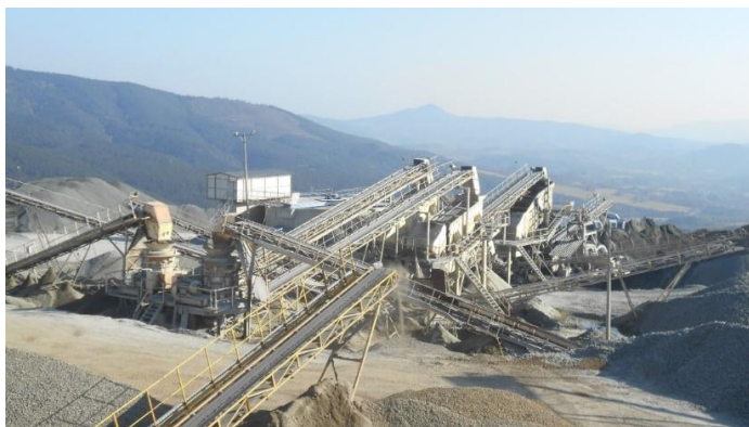
Слика 2. Дробилично-сепарационо постројење дијабаза на сепарацији "Мрчићи" (Извор, Д.Сакић, фебруар 2025.)
