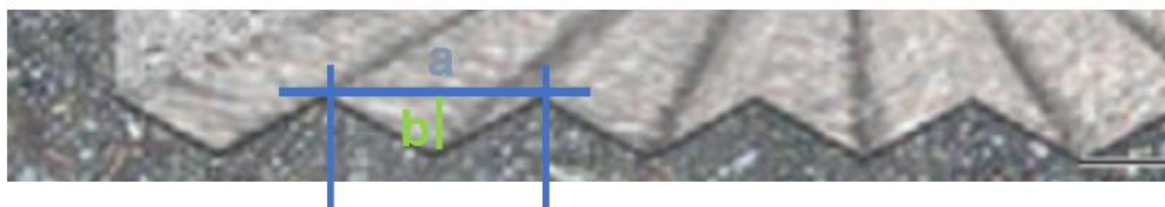
Slika 9. Izduženje geomreže na struganoj podlozi
