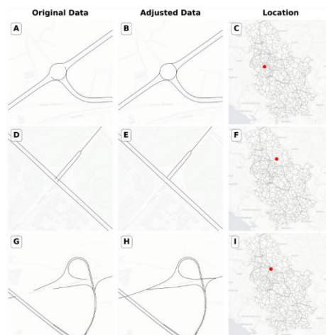
Slika 3. Tri primera prilagođavanja mreže radi obezbeđivanja potpune povezanosti.
