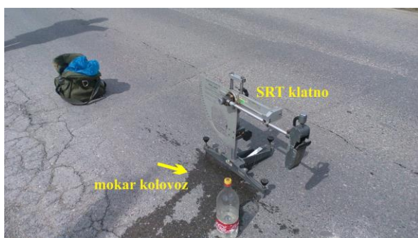
Slika 2. Merenje otpornosti na klizanje kolovoza SRT klatnom na putnom pravcu IIA reda Topola – Bučin grob pre rehabilitacije (Izvor: Institut za puteve, Odeljenje za kolovozne konstrukcije, mart 2016.).
