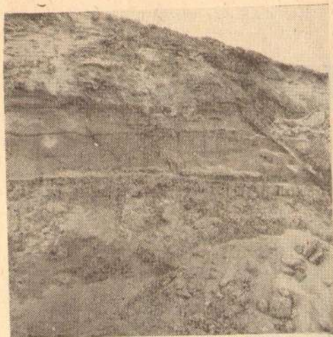
Сл. 7. Профил позајмишта пред прелазом за Коларе, око 42-ог км. У подини је високо пластична сива глина, затим око 3 м слабо везаног пешчара (у средини) и горе, опет, смеђа глина. Десно се види косо оријентисана раван (елементи) пада 345/54) дуж које је кретан лесни покривач, преко глина и пескова, ка путу.
