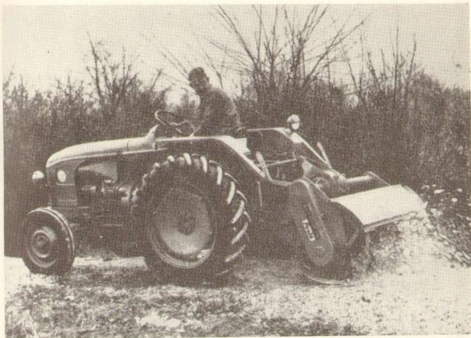
Сл. 16. Ротаватор за ситњење и мешање материјала „Rotavator” са прикључком за трактор Renault D-35. Радна ширина 1,25 м, тежина 315 кг.
