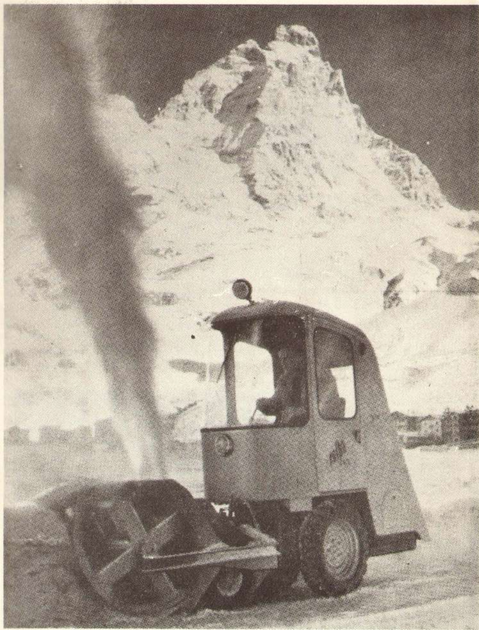
Сл. 19. Турбинска глодалица за снег „Rolba 2012” са могућношћу рада на ширини од 2,0 м и одбацавањем материјала на страну.
