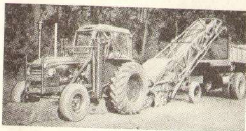
Сл. 14. Утоваривач материјала уфигурисаног у подужну фигуру „Астак” капацитета 100 м 3 /час (прикључак на трактор Renault D-35).
