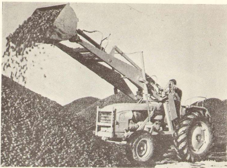
Сл. 18. Хидраулични утоваривач „Fauchaux J.R.K” са капацитетом кашике 0,35 м 3 . Користан терет 500 кг, максимална висина испод машине 3,5 м (2,85 м испод кашике при истовару).
