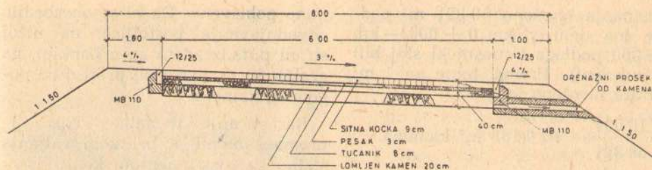
SI 3 KOLOVOZNA KONSTRUKCIJA NA PUTU BEOGRAD - PANČEVO
