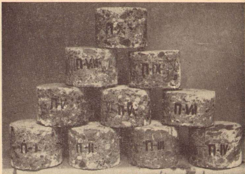
Sl. 8. Izgled svih betonskih cilindara po valjanju
