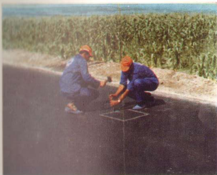
Сл. 6 — Вађење узорка за испитивање коловоза
