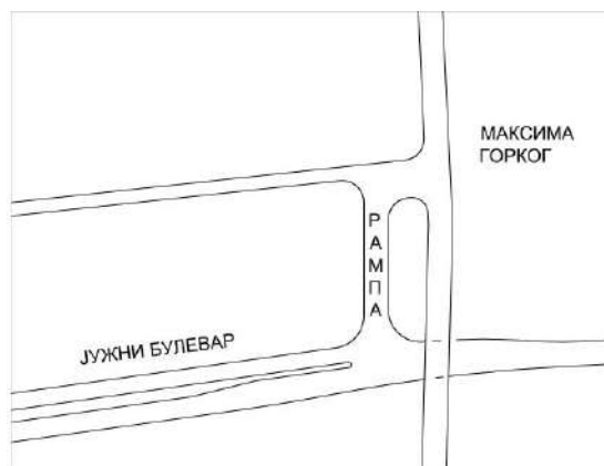
Слика 14: Ситуациони план денивелисаног решења са две површинске трокраке раскрснице повезане рампом
