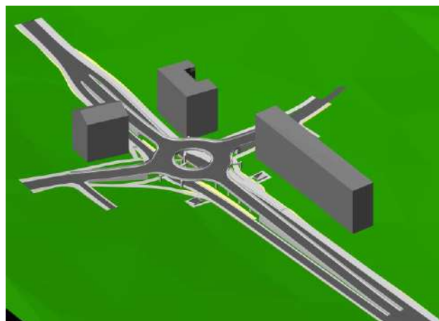
Слика 1 : Идејно решење денивелисане раскрснице типа „Кружни подеоник“
