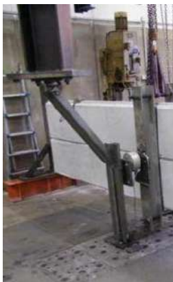
Slika 7. Dinamički testa opterećenja sa 2 različita testa i sa 5 miliona promena tereta (oscilacije)
