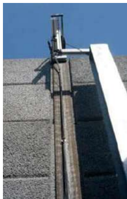
Slika 7. Dinamički testa opterećenja sa 2 različita testa i sa 5 miliona promena tereta (oscilacije)
