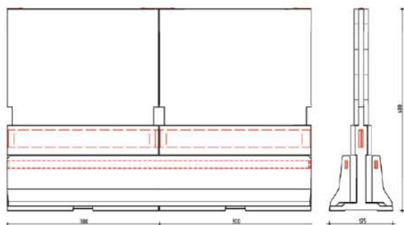
Slika 5. Zaštitna i integrisana ograda protiv buke za srednju traku novo zadržavanja za 38 tonski tegljač – H4b in radne širine W5.
