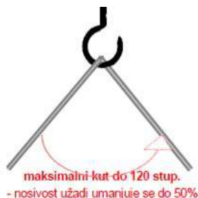
Слика 4. Правилан захват терета и угао ужади са којим се подиже терет
