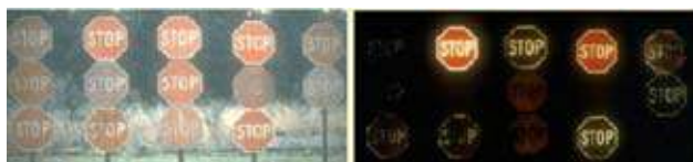
Slika 3. Saobraćajni znakovi u dnevnim i noćnim uslovima u zavisnosti od koeficijenta retrorefleksije
