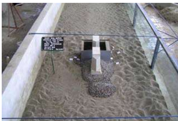
Slika 5: Hidrauličko fizičko ispitivanje modela temelja u reci u Institutu Jaroslav Černi
