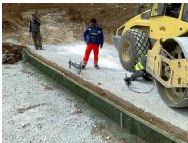
Slika 10: Merenje nabijenosti nasutog materijala
