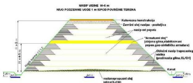
Слика 3. Израда насипа H > 6 m, Н.П.В. 1 m испод површине терена
