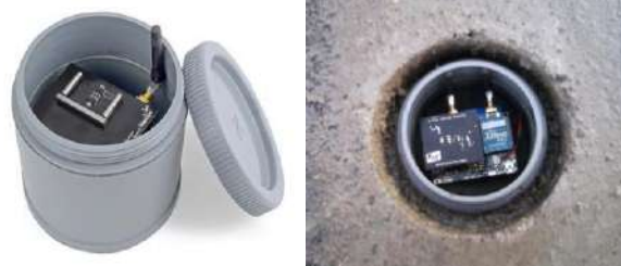
Слика 2. Паркин сензор у ПВЦ кућишту укопан у асфалт [4]
