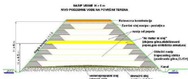
Слика 7. Израда насипа H > 6 \text{ m} , N.P.V. на површини терена
