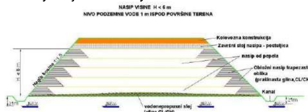
Слика 2. Израда насипа H < 6 m, Н.П.В. 1 m испод површине терена
