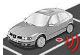
Слика 7. Сензор укопан у паркинг простору [4]
