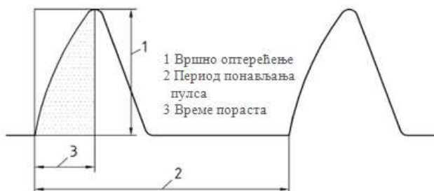
Слика 6. Облик пулса оптерећења, који показује време пораста и вршно оптерећење
