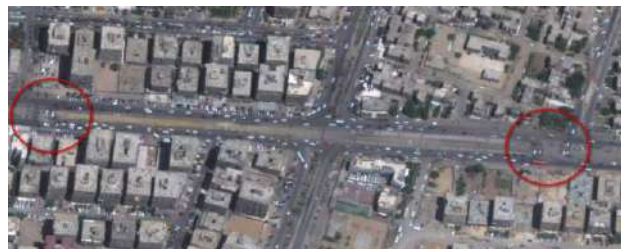
Slika 5. Raskrsnica u Kairu na kojoj su izgradnjom razdelnog ostrva fizički onemogućena kretanja pravo i desno sa sporednih prilaza.
