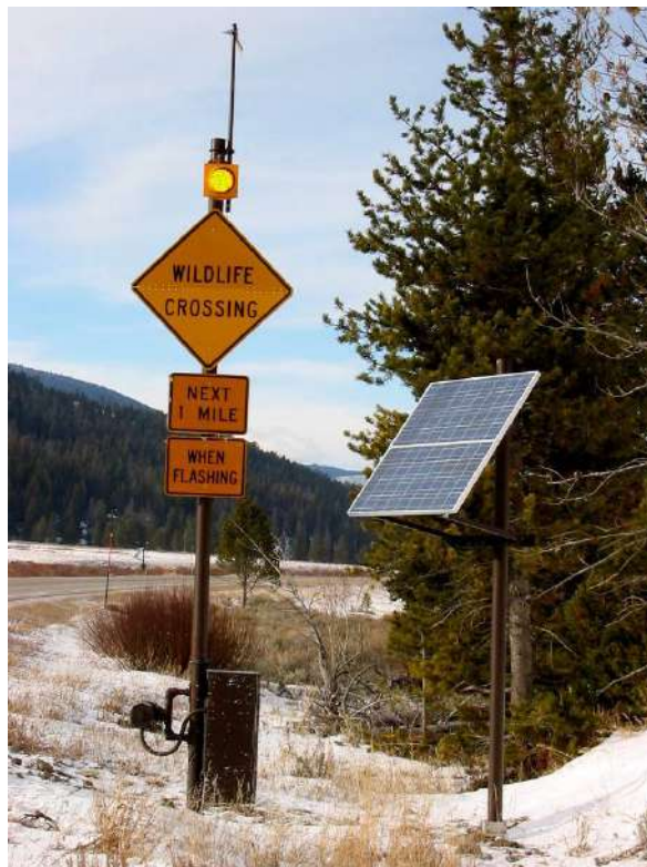
слика 8. Систем сензора за детекцију крупних животиња у близини пута
