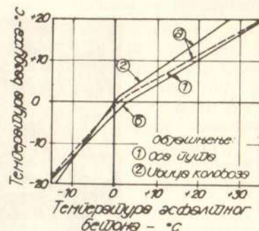
Сл. 4 — Температура асфалтнобетонског застора на дубини од 5 cm у зависности од температуре ваздуха у периоду фебруар—јули (а) и август—јануар (б)
