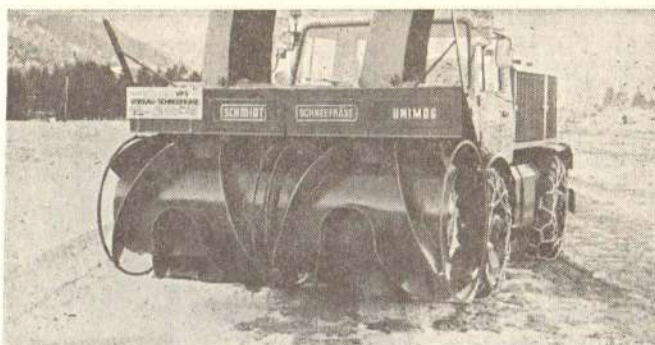
Сл. 3 — Уребај за чишћење и одбацивање снега „Schmidt-Unimog“
