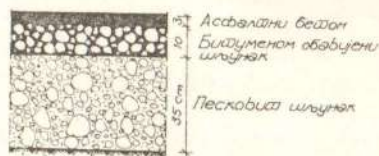
Сл. 2 — Пресек коловозне конструкције пута
