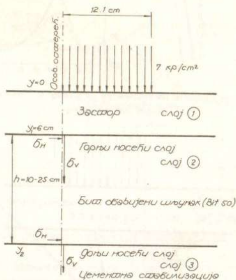
Сл. 9 — Пресек коловозне конструкције која се анализира с обзиром на могућност стварања колотрага
