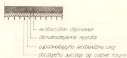
Сл. 5 — Пример израде асфалтне појачања преко заштора од ситне коцке уз примену полиестерске мреже
