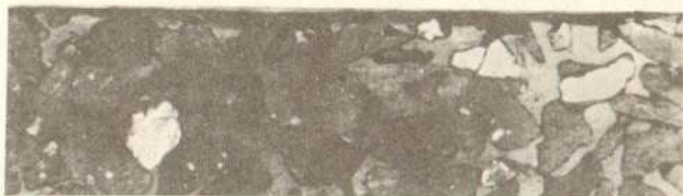
Сл. 6 — Асфалтноцементни бетон (пресек кроз слој)
