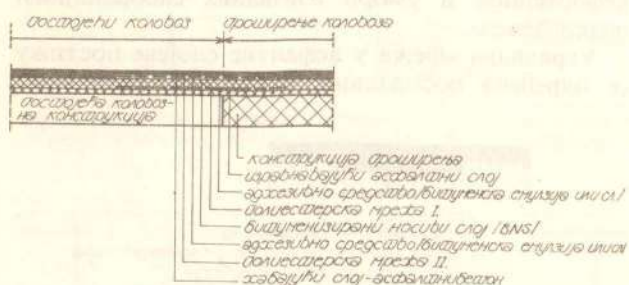
Сл. 7 — Принципијелан приказ једностраног проширења и појачања постојећег коловоза
