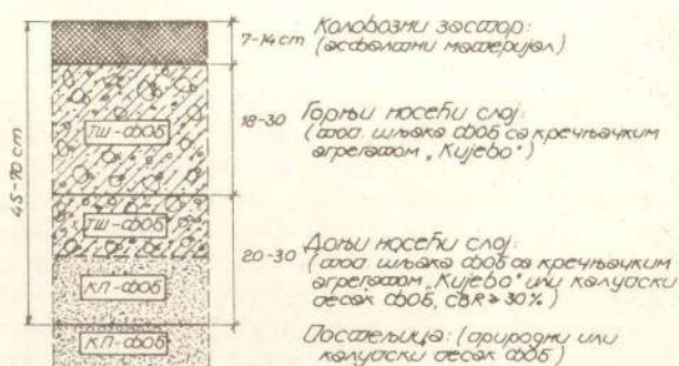
Сл. 3 — Топионичка шљака у саставу коловозне конструкције
