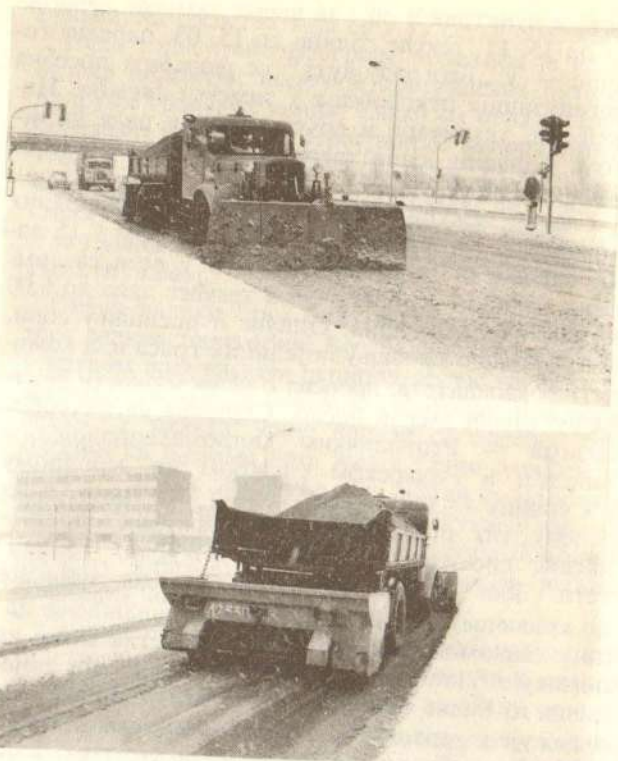
Сл. 2 и 3. Основно возило за зимску службу са опремом за чишћење снега и посипање соли
