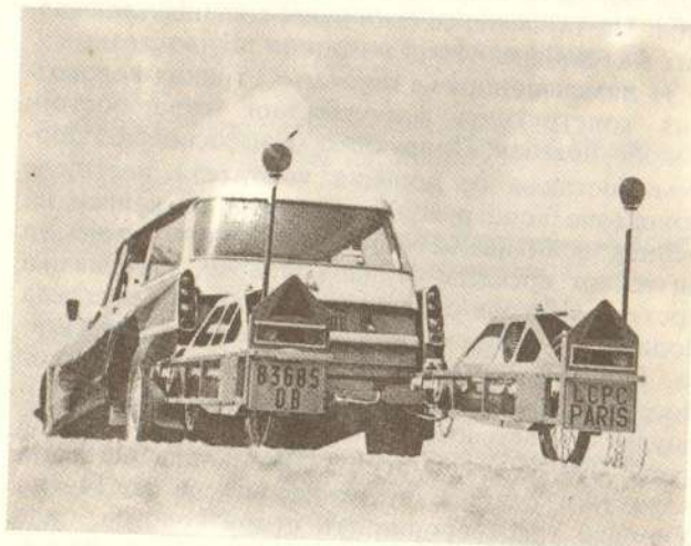
Сл. 5 — „A. P. L.“ — анализатор подужног профила
