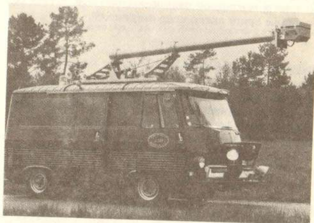
Сл. 6 — „Žervo“ — уређај за снимање оштећења на површини коловоза.
