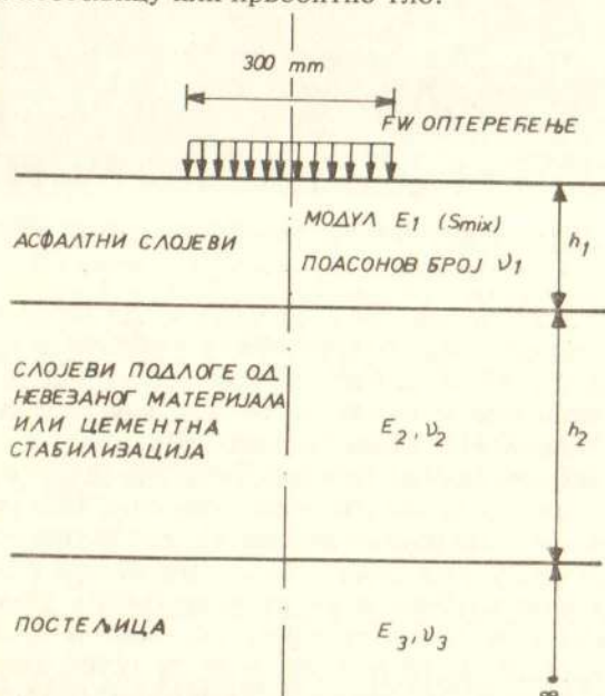
Сл. 5 — Модел коловозне конструкције испод оптерећења
