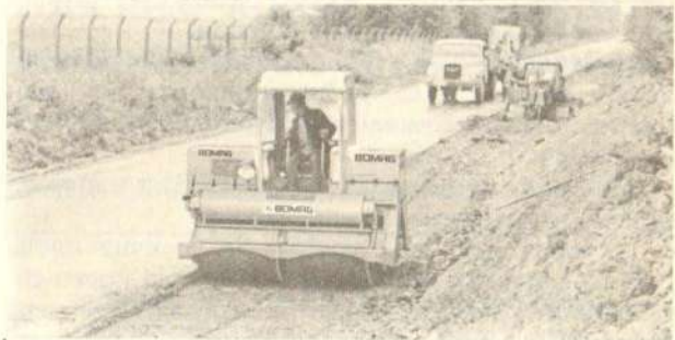
Сл. 2 — Ваљак са двоструким вибрацијама на сва четири точка BW 200 (производи „Рико“ из Рибнице)
