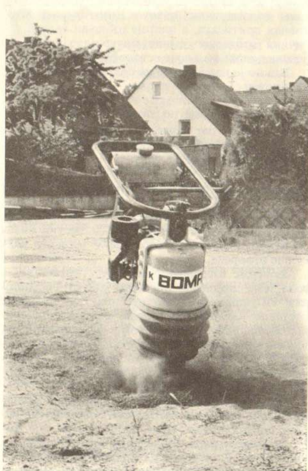
Сл. 5 — Вибрациони набијач BT 70 (производи „Јелинић рад“ из Бања Луке)
