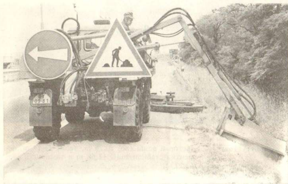
Сл. 10 — Машинско кошење траве на косина насипа на ауто-путу
