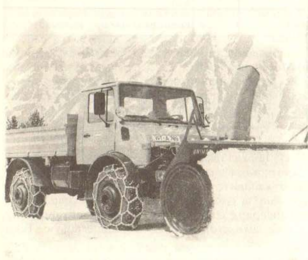
3 — Специјална фреза с лопата откопава у условима окупљања „Београд-пут“
