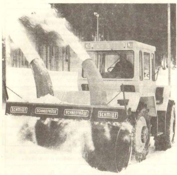
Сл. 4 — Лопца од нижих специјалних фрези са великим утицајем каквих нема у опреми за зимску службу код нас
