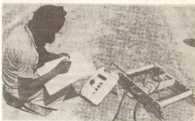
Сл. 17 — Одређивање просечне влажности материјала у слоју 1 магадензитометром ГПВ 10-22,5
