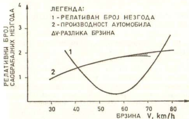
Сл. 1. — Зависност реалног броја саобраћајних незгода и производности аутомобила од брзине кретања.
