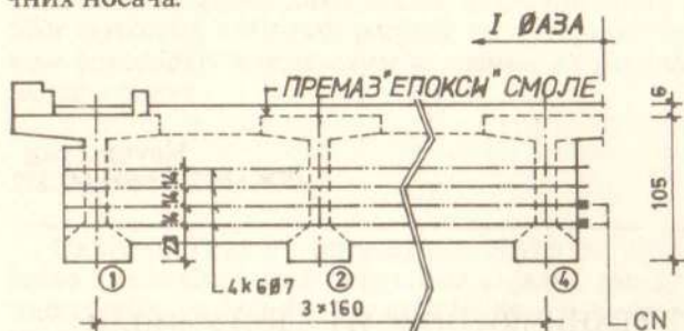
Сл. 9. Фазно извођење попречних носача - решење помоћу наставних котви
