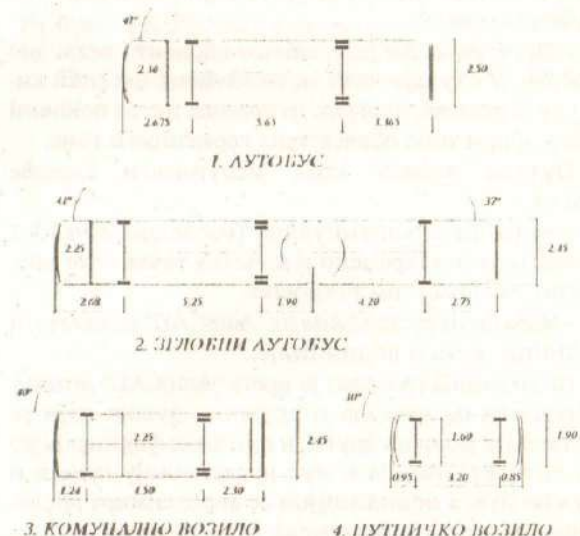
Сл. 9. Карактеристике меродавних возила за пројектовање градских саобраћајница
