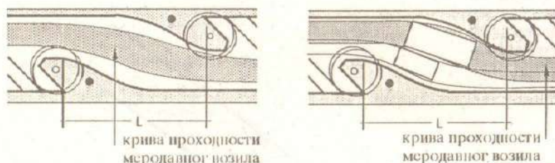
Сл. 4. Провера проходности и могућности мимоилажења возила у зонама дисконтинуитета у ситуационом плану улице са умиреним саобраћајем
