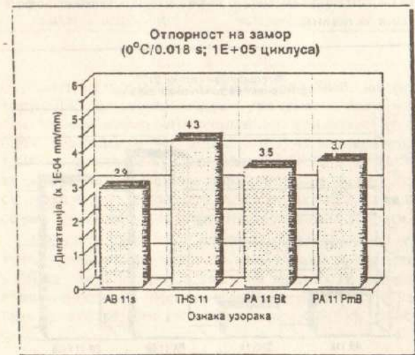
Сл. 5. Отпорност асфалтних мешавина на замор на 0^{\circ}\text{C}/0.018\text{ s} ( 1\text{E}+05 циклуса)
