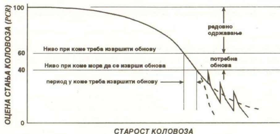
Слика 2 – Нивои одржавања коловоза у функцији од његовог стања и века трајања
