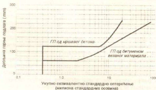
Слика 2 – Графичка метода J. P. Watson-a за димензионисање горње подлоге
