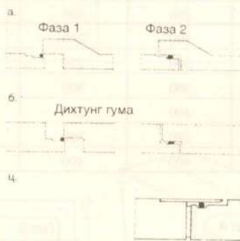
Слика 9 – Заптивање споја цеви: а) са муфом, б) са фал-цом, ц) за утискивање
