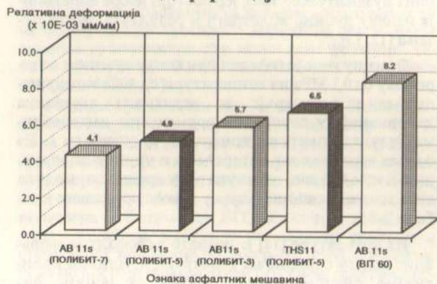
Слика 1. Деформација асфалтних мешавина са различитим полимер-битуменима
