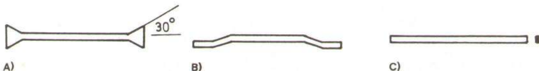
Слика 5. Типови металних влакана
