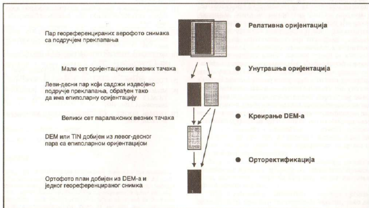
Слика 1. Процес добијања ортофото плана и DEM-а
