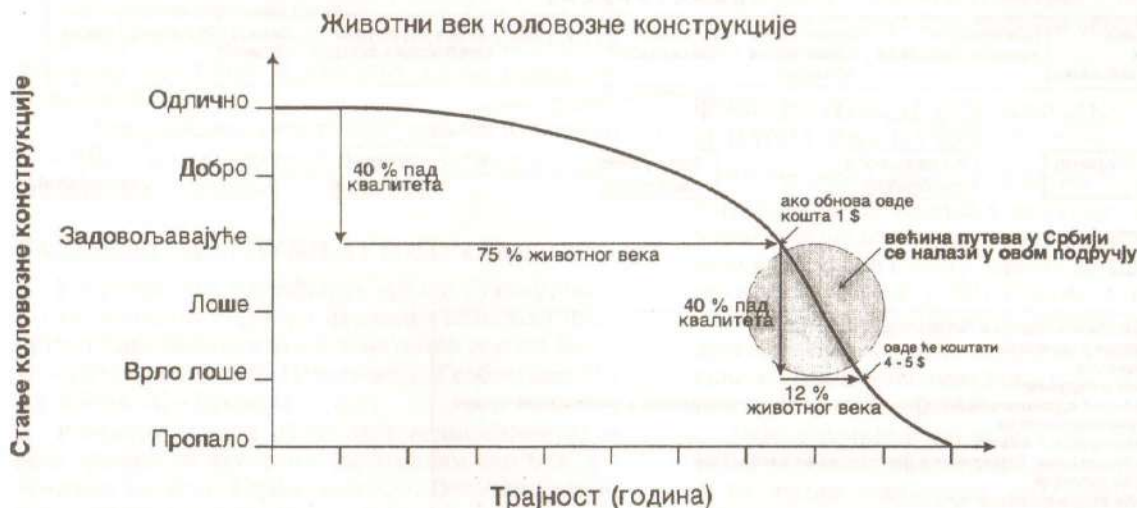
Слика 1. Илустрација животног века коловозне конструкције у зависности од њеног стања, века трајања и уложених средстава за одржавање
