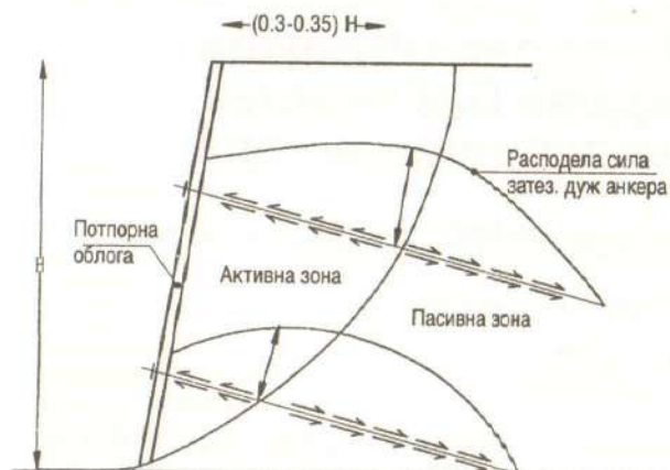
Слика 1. Илустрација понашања анкера при пријему оптерећења
