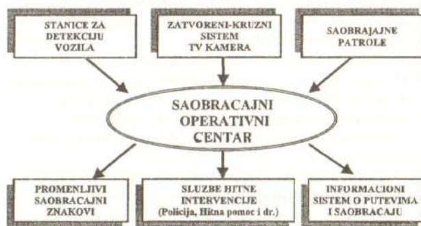
Слика 1. Шемајски приказ функционисања једног савременог система управљања саобраћајем
