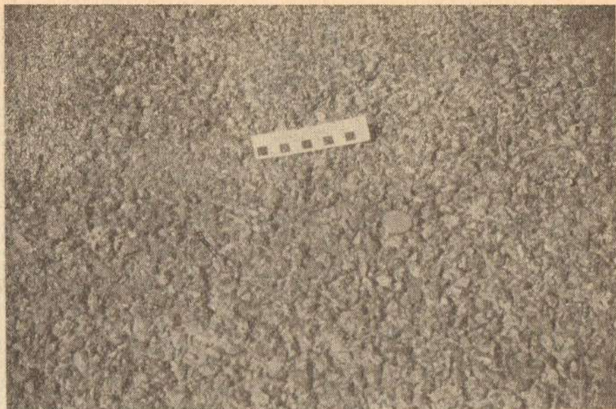
Тип II. Крупноћа зрна до 15 мм. Некономичан због слабог коришћења свих фракција агрегата
