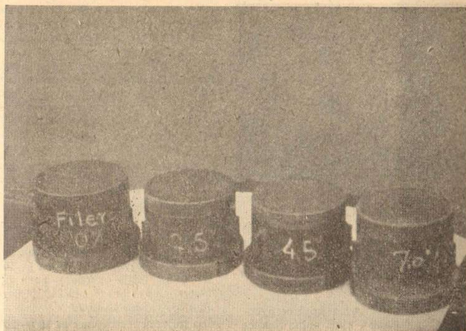
10 Узорци G_1 , G_2 , G_3 и G_4 израђени са разним количинама филера и 2% хидратизаног креча
