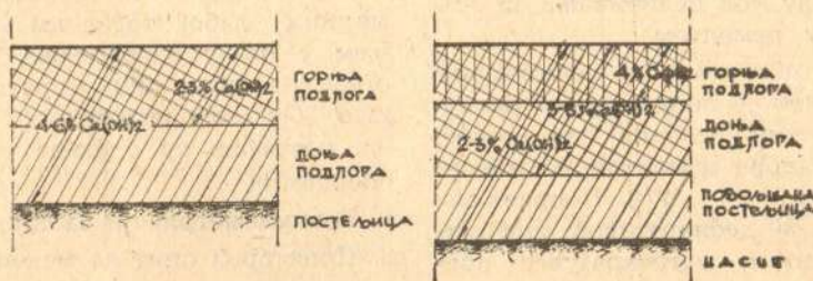
ПРИМЕРИ СТАБИЛИЗАЦИЈЕ КРЕЧОМ У ИЗРАДИ КОЛОВОЗНЕ КОНСТРУКЦИЈЕ
