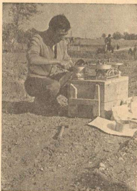
Сл. 5. Одређивање запреминских тежина цилиндром.
