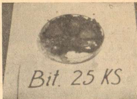
Сл. 20. Узорак израђен са битуменом 25 KS. На папиру се види како је битумен под утицајем горива за реактивне моторе исушио.
