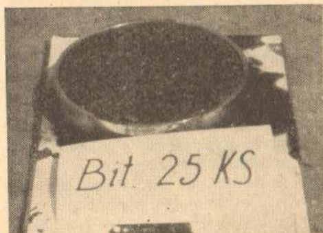
Сл. 21. Узорак израђен са битуменом 25 KS, под утицајем горива за реактивне моторе потпуно се распао и зрна оголила.
