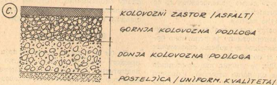
SL. 1 OSNOVNI OBLICI KOLOVOZNE KONSTRUKCIJE
